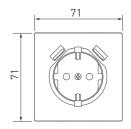
Механизм розетки с заземлением на 1 пост и 2 USB Туре А порта.
